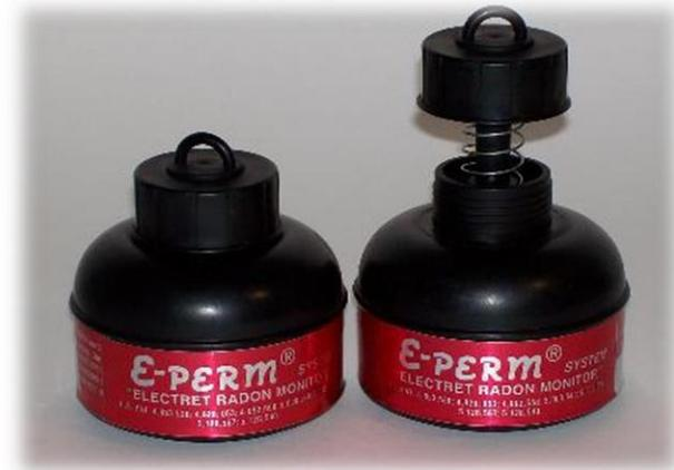
L'aria della camera, ionizzata dalle particelle alfa, provoca una perdita di potenziale dell'elettrete
